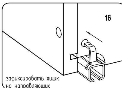
посредством регулировочного колесика можно регулировать ящик по высоте до +2мм
