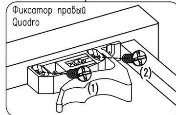
1. Прикрепить фиксатор Quadro к передней стенке ящика саморезом 3,5x16(1)
